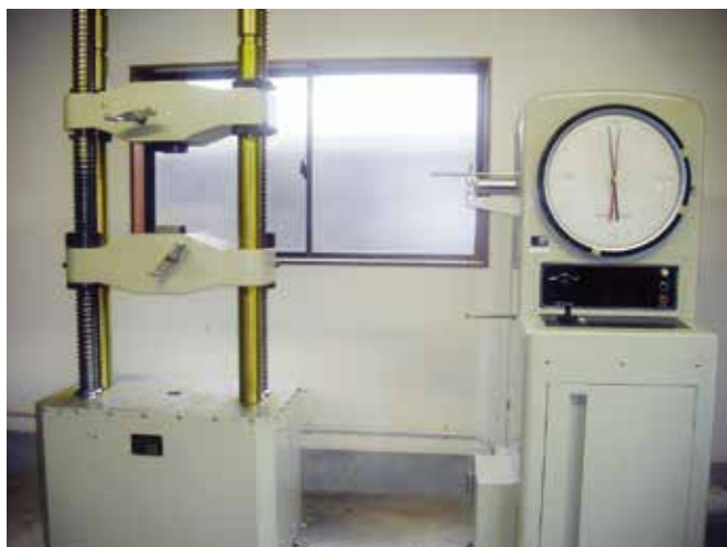
油圧式万能試験機 RU-TK8 (株)東京衡機製
